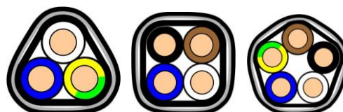
Схема расцветки изолированных жил
